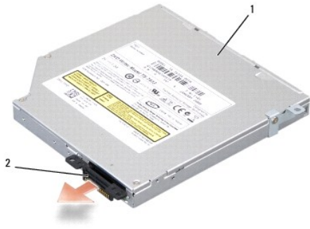
1 光盘驱动器 2 光盘驱动器插板
